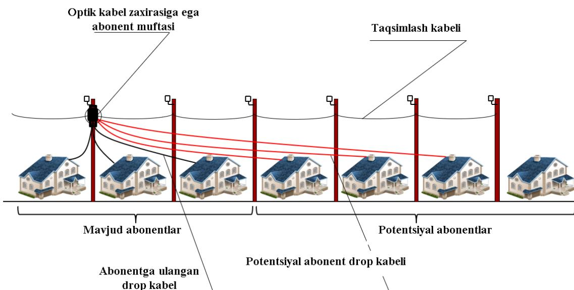
**1-rasm.** Taqsimlash kabelini (drop kabel) yotqizish va abonentlarni ulash uchun keng tarqalgan variant.
