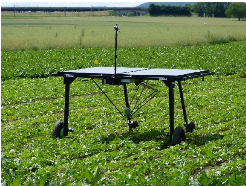
2-rasm. Ecorobotix avtonom mobil robot dalani begona o‘tlardan tozalash jarayoni.
